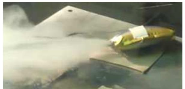
Abb. 1: Zersetzung von kleinem Li-Ion Akku. Ausdehnung der Zelle und Abblasen („Venting“). Stichflammenbildung steht kurz bevor.
