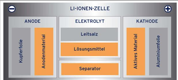
Abb. 2: Prinzipieller Aufbau von Li-Ionen Zellen mit den vier grundsätzlichen Komponenten Anode, Kathode, Elektrolyt und Separator; die rot hinterlegten Komponenten können einen Brand beeinflussen.
